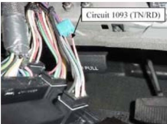
FOR ENGINE START, SPLICE INTO CIR. 1093 (THE TAN / RED WIRE) IN THE LOCATION SHOWN.
