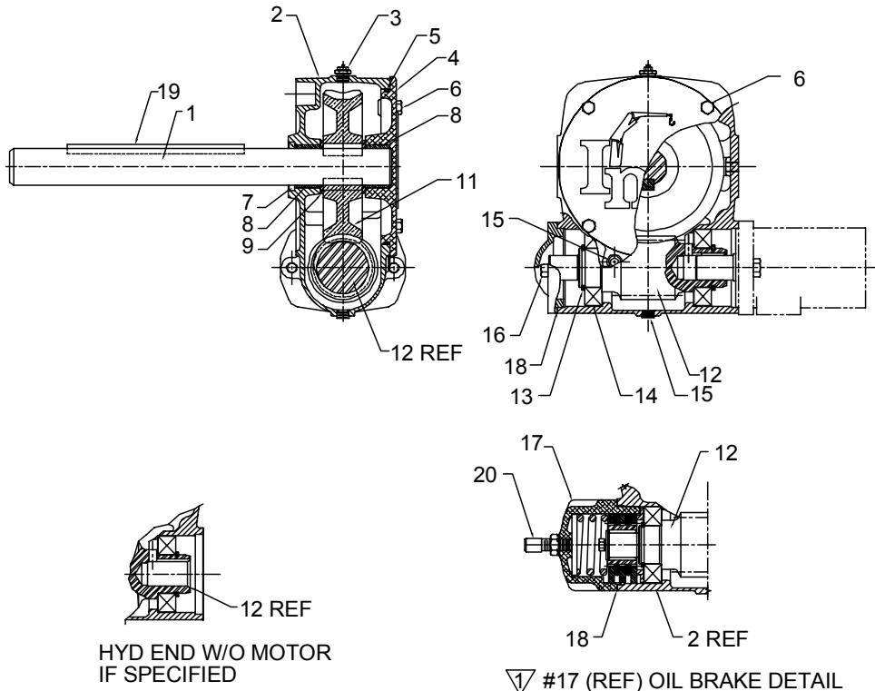
BRAKE TORQUE SETTING - 8 FT-LB AT WORM INPUT
