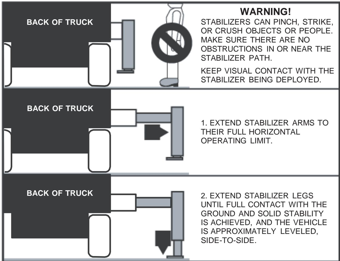
FIGURE J-13. STABILIZER DEPLOYMENT SEQUENCE
